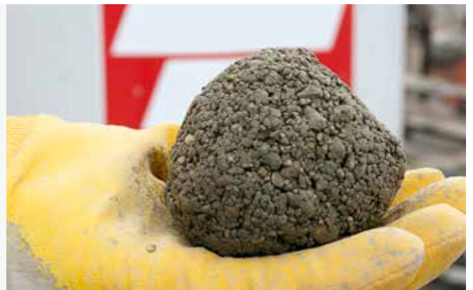
Zo ziet legmortel met de ideale consistentie eruit
